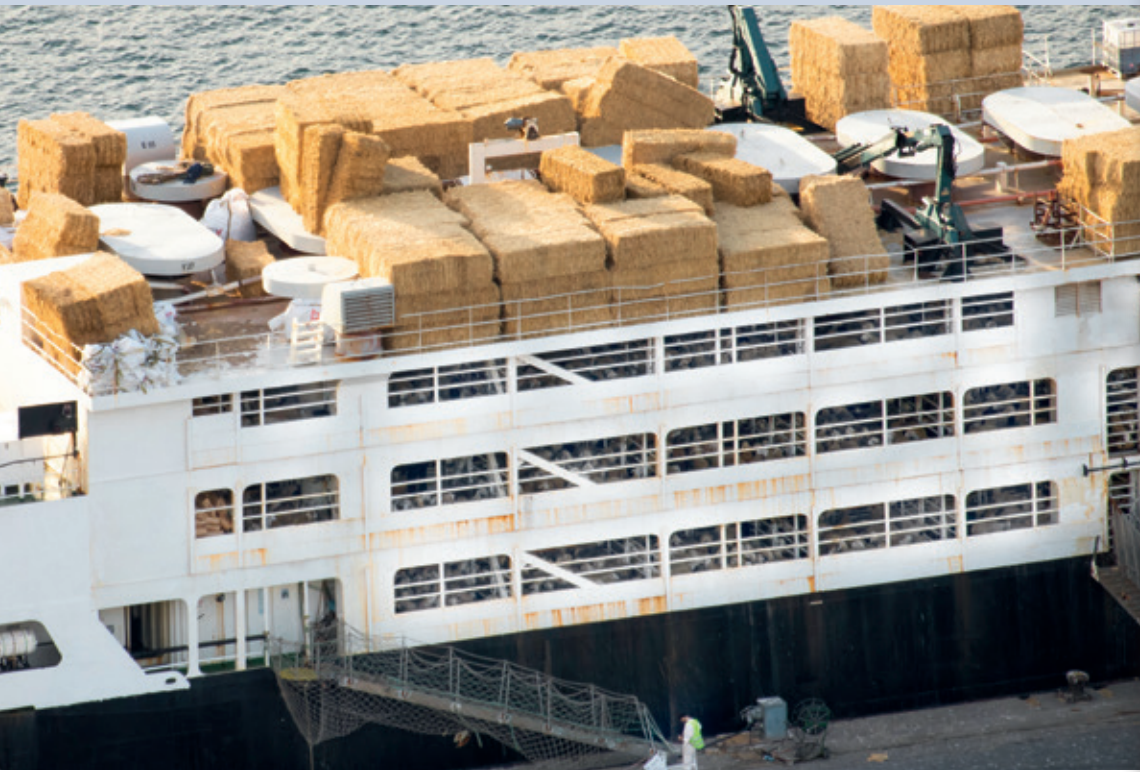
Auf einen ehemaligen Frachter aufgesetzte Decks mit Pferchen. Auf dem obersten Deck wird Heu gestapelt. Bei rauer See trägt beides zum Risiko bei, dass das Schiff aus dem Gleichgewicht gerät und kentert.
