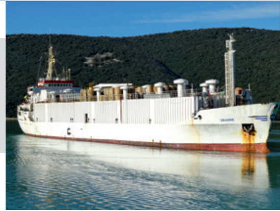
Bild oben: Der komplette rechteckige Aufbau wurde nachträglich auf diesen uralten Frachter aufgesetzt.
